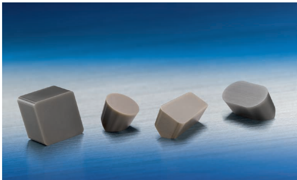
1 Schneidplatten aus den SiAlON-Keramikschnidstoffen CSL125 und CSL725 zum Drehen und Stechdrehen von HRSA-Werkstoffen. Sie bieten sich an für das Schruppen und mittlere Bearbeitungsschritte, bei denen eine hohe Produktivität gefordert ist, (© CeramTec)
