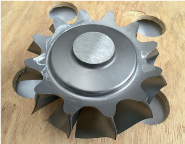
3 Turbinenrad aus Inconel 713, wie es für stationäre Gasturbinen oder Abgasturbolader verwendet wird, als Rohling (links) und als Fertigteil (rechts) (© CeramTec)
