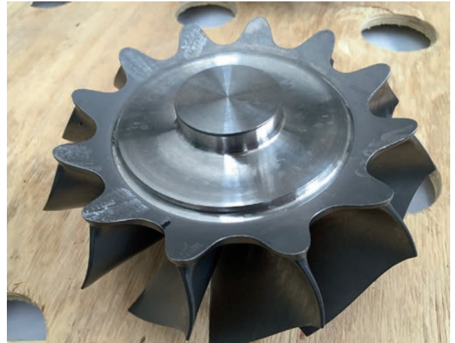
3 Turbinenrad aus Inconel 713, wie es für stationäre Gasturbinen oder Abgasturbolader verwendet wird, als Rohling (links) und als Fertigteil (rechts) (© CeramTec)
