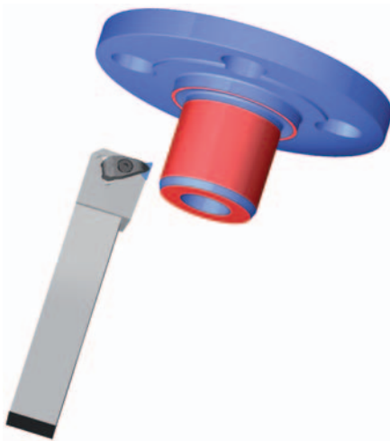
4 Längs- und Plandrehen einer Radnabe mit 58 bis 62 HRC bei erhöhter Schnittgeschwindigkeit
