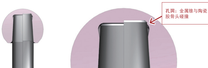
图4: 兼容性示例: 两个名义上相似但设计不同的12/14颈锥与陶瓷股骨头配合图示
