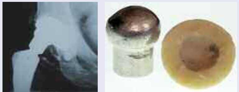
Couple de frottement métal – céramique non autorisé, à 6 mois in vivo (à gauche) et après l'explantation (à droite)
