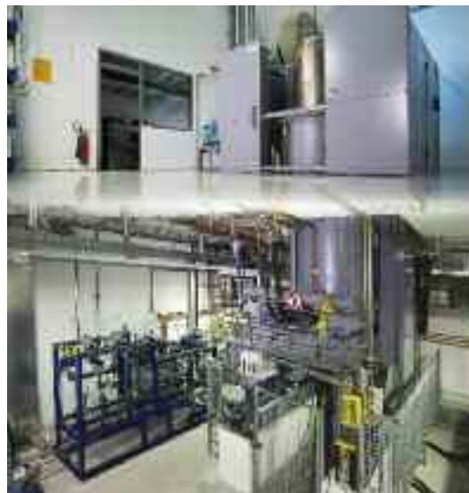
Presse isostatique à chaud pour densifier la céramique à Marktredwitz (Montage photo)
