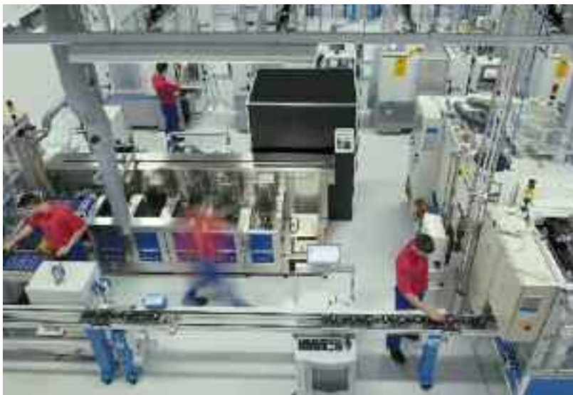
Ligne automatisée d'usinage des têtes fémorales à Marktredwitz
