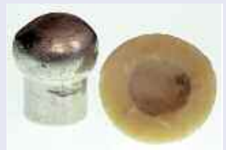
Unzulässige Metall/Keramik-Gleitpaarung, 6 Monate in vivo (links) und nach der Explantation (rechts)
