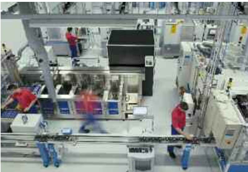
Automatisierte Hartbearbeitungslinie für Kugelhköpfe in Marktredwitz
