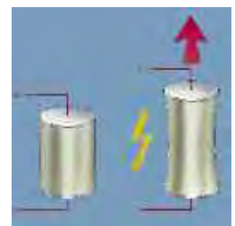
Fonctionnement de la céramique piezo
