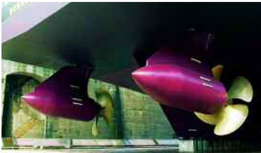
Les arbres d'hélice du Queen Mary II fonctionnent avec des bagues en céramique provenant de chez CeramTec
