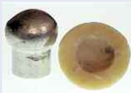
Accoppiamento metallo/ceramica inammissibile, 6 mesi in vivo (a sinistra) e dopo l'espianto (a destra)
