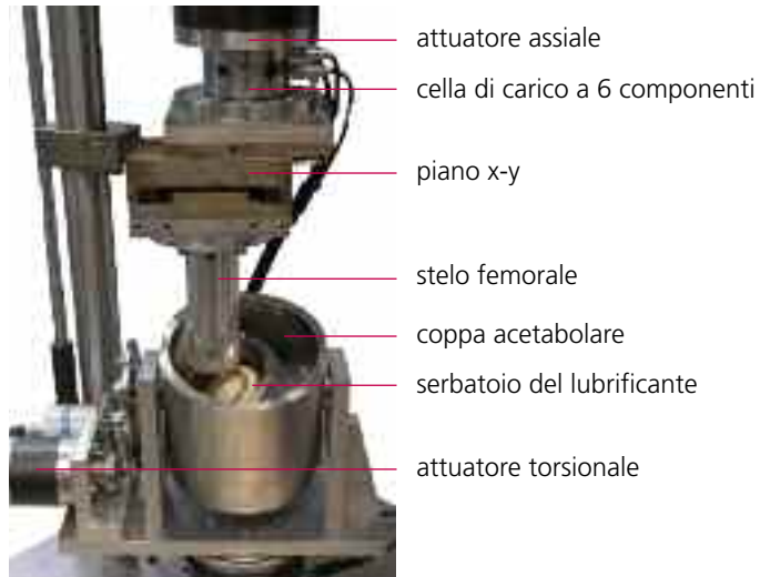
Simulatore d'anca per misurazioni acustiche: Tramite la vibrometria laser e la analisi sensoriale del suono in aria vengono esaminati i cicli di carico e di movimento al verificarsi di oscillazioni e cigolii.
