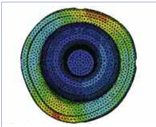
Beispielhaftes Berechnungsergebnis: Stark überhöhte Maximaldeformation einer Pfanne während eines Quietschens. Die Pfanne bewegt sich relativ zur Kugel so, dass eine kohärente Schwingung entsteht, die sich als Quietschen bemerkbar macht.
