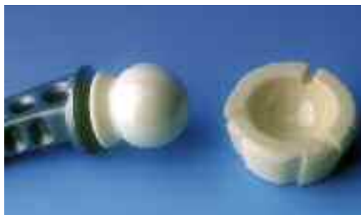
Eine der ersten Keramik/Keramik-Gleitpaarungen
