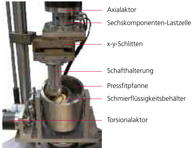
Hüftsimulator für akustische Messungen: Mit Laservibrometrie und Luftschallsensorik werden Last- und Bewegungszyklen auf das Auftreten von Schwingungen und Geräuschen untersucht.
