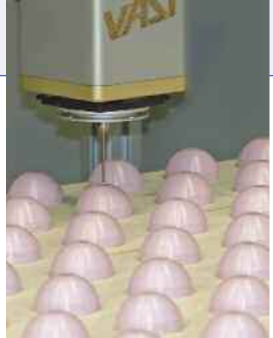
Bei der automatischen Vermessung der Inserts werden für jede einzelne Komponente alle Daten online erfasst und im Qualitäts-Modul gespeichert.
