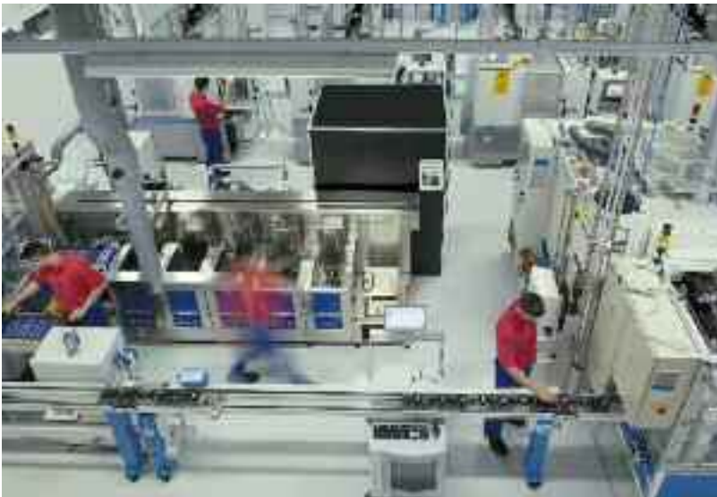
Automatisierte Hartbearbeitungslinie für Kugelhköpfe in Marktredwitz
